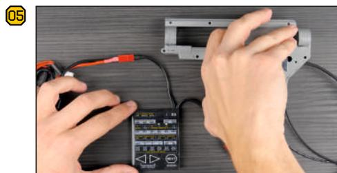
Lentamente, girando la cremagliera verificare se il sensore rileva i denti.
