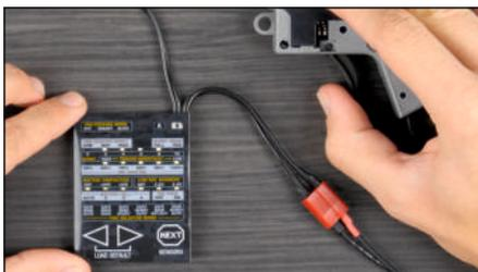
Premere lentamente il grilletto. I diodi TRIGGER SENSORS si accendono uno ad uno. Essi indicano sensori attivi. Nel caso di alcuni grilletti i primi sensori possono essere attivi nonostante che il grilletto sia stato liberato.
