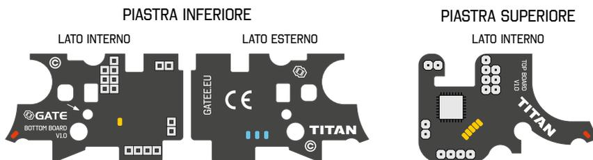
I sensori ottici hanno eliminato il problema dei commutatori difettosi che può essere presente nei mosfet drop-in della concorrenza. Il grilletto non ha nessuna connessione meccanica con la piastra PCB. Cio' elimina il carico meccanico e garantisce elevata affidabilità.
