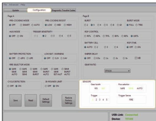
Passa alla scheda Configuration. Nel campo SENSORS nel tempo reale viene visualizzato lo stato dei sensori.
