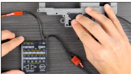
Verificare se i sensori riconoscono la piastra del selettore. Spostando la piastra del selettore verificare se TITAN rileva la posizione SAFE, SEMI e AUTO.
