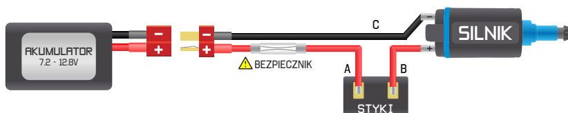
RYS. 1. STANDARDOWA INSTALACJA AEG
